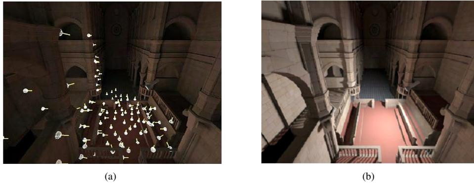
Figura 13: Despliegue de una escena donde (a) es inyectada con un conjunto de luces virtuales e, (b) iluminada con *instant radiosity*.
