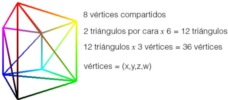
Figura 5: Cubo de ejemplo con su especificación geométrica.
